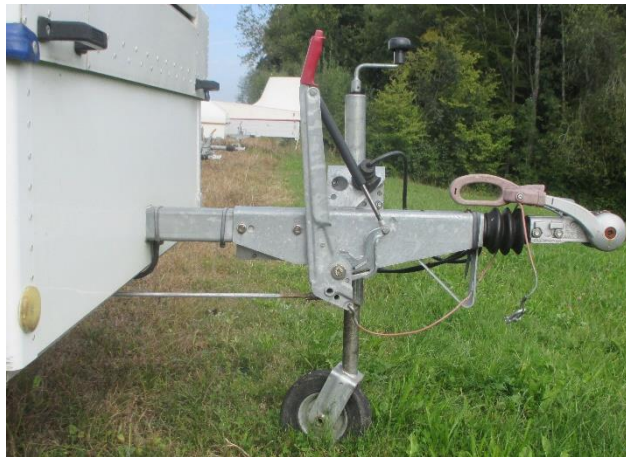
Diese Bremse muss nachgestellt werden
